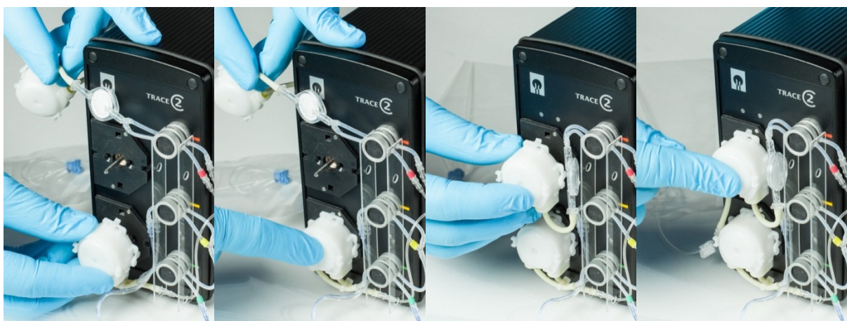
Abbildung 34: Aufstecken und Anklicken der unteren Pumpenkassette P2 und der oberen Pumpenkassette P1
