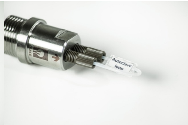
Abbildung 56: Verschließen der Sonde vor dem Sterilisieren
