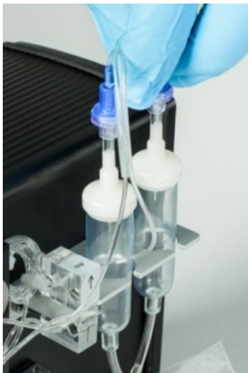
Abbildung 39: Einstecken der Tropfenzähler in die Halterung
