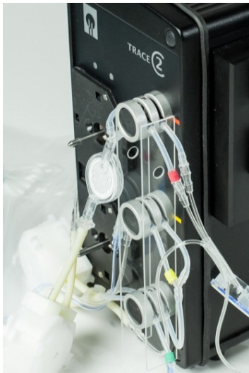
Abbildung 32: Sichern der Ventilschläuche durch Führungsplatten
