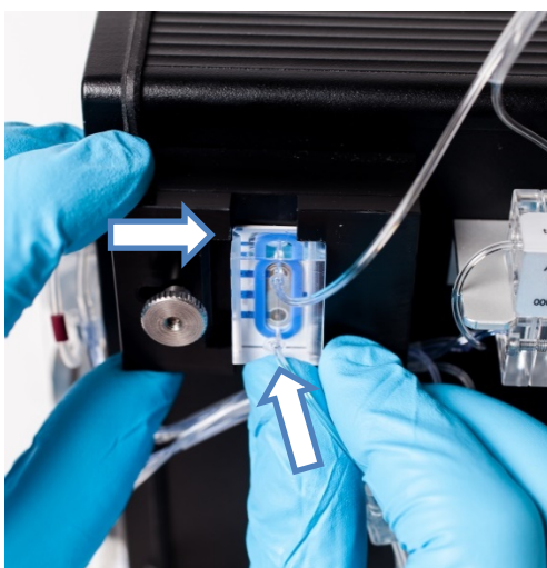
Abbildung 37: Fixieren der Messzelle am Gerät
