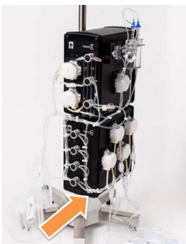
Abbildung 44: Montage der Pumpen am M4
