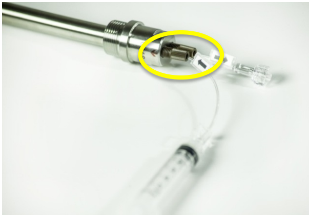
Abbildung 55: Füllen der Sonde mit Pufferlösung
