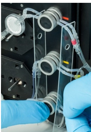
Abbildung 31: Manuelles Umschalten des Ventils, um den hinteren Schlauch sicher einzusetzen.
