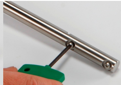
Abbildung 52: Festziehen der zwei Schrauben
