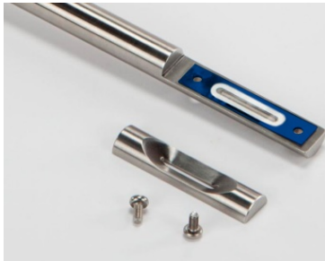
Abbildung 50: Einlegen der Membran
