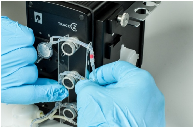
Abbildung 29: Positionierung der Ventilschläuche am Gerät
