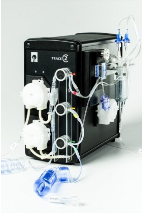
Abbildung 27: Ansicht Frontseite fertig verschlaucht für die Betriebsart Filtration
