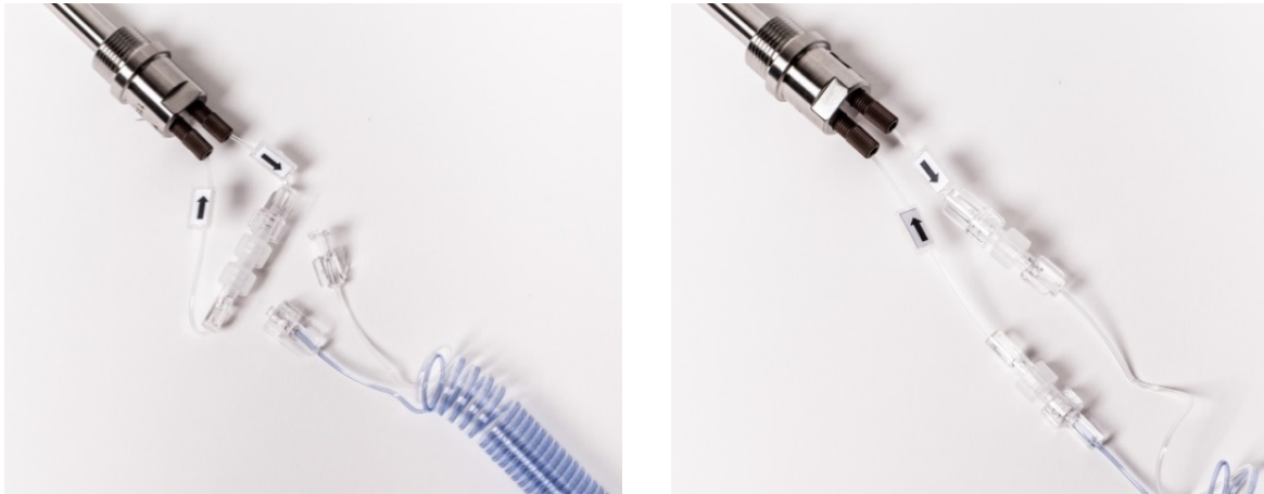
Abbildung 57: Anbindung der Dialysesonde an das Schlauchset
