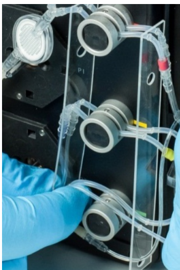
Abbildung 30: Spannen und Einlegen des Schlauchpaares
