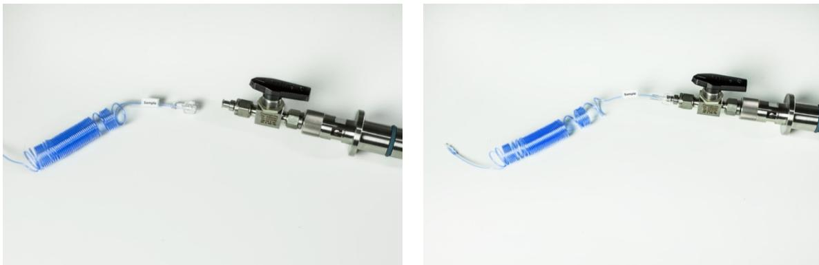
Abbildung 10 und 11: Anschluss der Filtrationssonde an das Schlauchset
