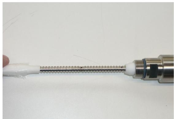
Abbildung 6: Aufstecken der Polypropylenmembran
