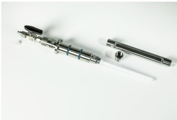
Abbildung 7: Aufgesteckte Polypropylenmembran
