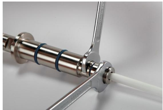
Abbildung 8: Anziehen der Überwurfmutter
