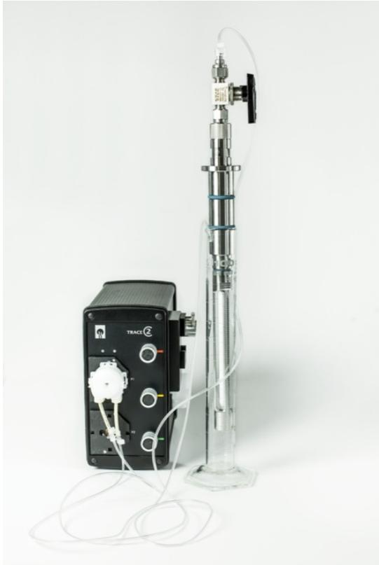
In einem Standzylinder ausreichender Länge wird die Sonde so in die Hydrophilisierlösung getaucht, dass sich die Membran vollständig in der Flüssigkeit befindet.
