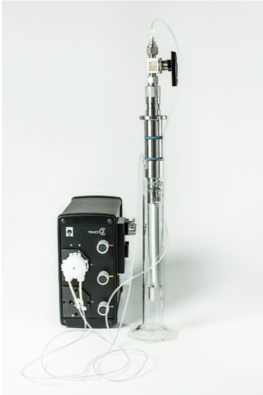
Abbildung 11: Aufbau Hydrophilisierung mit 25 mm Filtrationssonde
