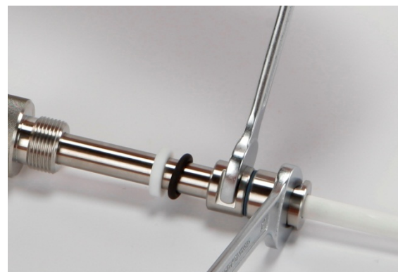
Abbildung 10: Anziehen der Überwurfmutter
