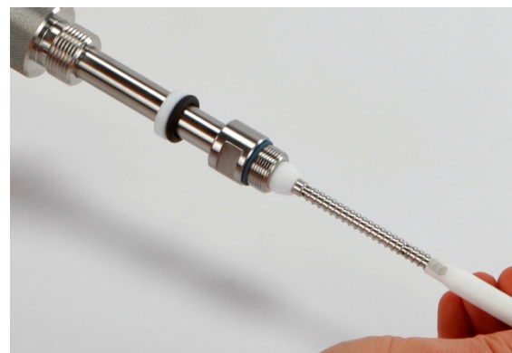
Abbildung 8: Aufstecken der Polypropylenmembran
