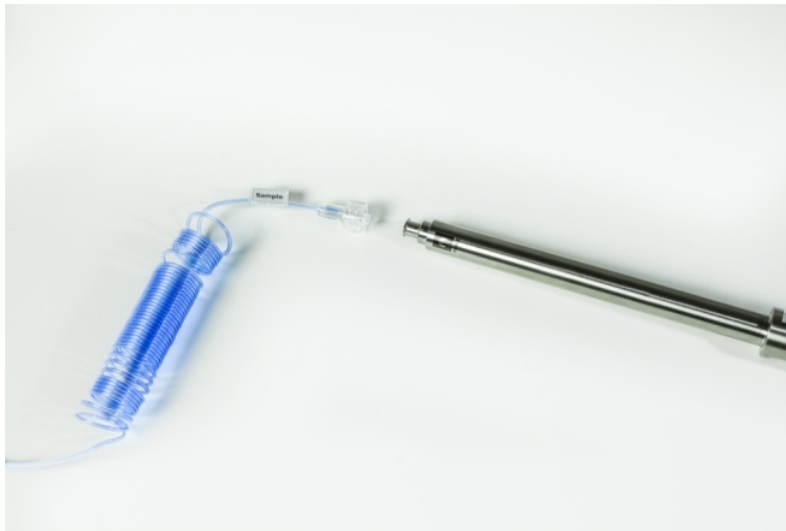
Abbildung 14: Anschluss der Filtrationssonde an das Schlauchset
