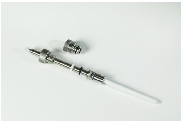
Abbildung 13: Filtrationssonde mit Reduzieradapter
