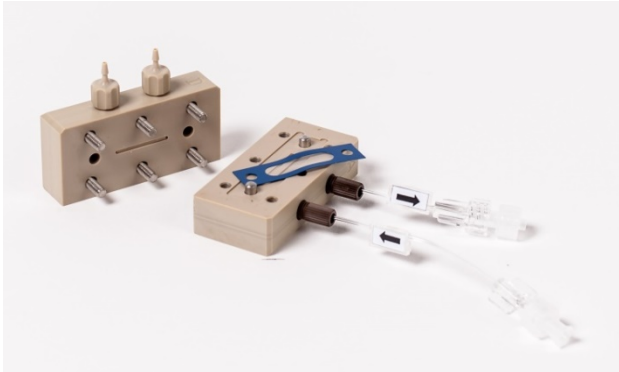
Abbildung 9: Bypassmodul PEEK mit Membransandwich Low
