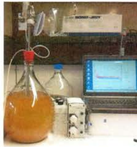
Abb. 4: Automatisierte enzymatische Messung von Glucose und Fructose während der Vergärung von Most
